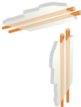
(Mineralische Putzüberdeckung auf dem Kabel  $\geq 15$  mm)
