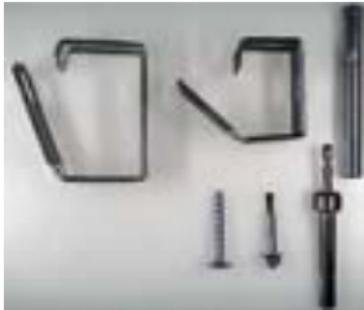
Zur Montage der Dätwyler E0 Sammelhalter an Beton können Dübel KDM benutzt werden. Werkzeuge: Bohrhammer, Bundbohrer SDS 1, Setzwerkzeug SWM-SM 50.
